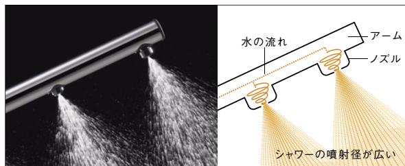
ノズル内の旋回流によって、広い範囲に均一に散水します。
